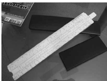
Une règle à calcul, fréquemment utilisée avant l'avènement des calculatrices.
